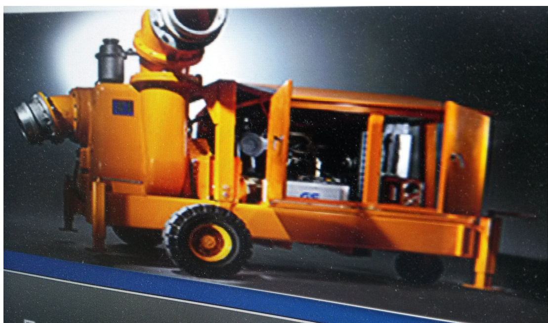
引擎直接驅動式——抽水機組
